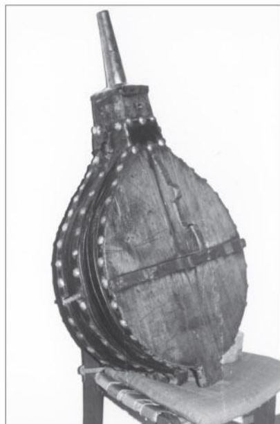
Un mantice delle dimensioni di un metro. Si trovava nella filanda Richenbach. Era fisso e veniva azionato tramite carrucole per soffiare aria che alimentava il fuoco sotto le caldaie.
