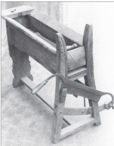
Ra tajaréna , un meccanismo perfetto tutto in legno che spinge in avanti le foglie di gelso e, con lo stesso movimento, le sminuzza.
