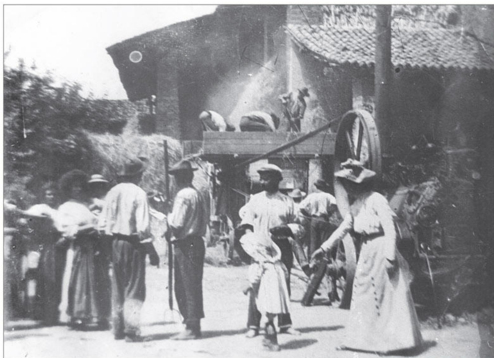
Via Palestro 1908. La trebbiatura, giorno di festa per tutti, un rito a cui assistono anche donne e bambini. La bambina di spalle è Maria Luisa Scacheri. Il locomobile a vapore fugó , caratterizzato dalla lunga ciminiera reclinabile, attraverso la cinghia di trasmissione impone il ritmo adatto alla trebbiatrice. Era finita per sempre l'epoca della varşèla . La macchina veniva portata di cascina in cascina o collocata in prossimità del ponte. In una giornata poteva trebbiare 130 quintali di grano.
