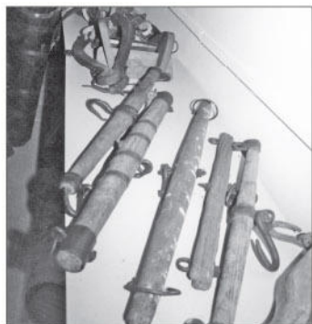
Stasöra o balansé per agganciare le tirelle degli animali all'attrezzo da usare. A destra, il räncapatàch .
