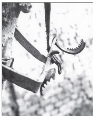
Il "piantapali" ideato dal fabbro Brunetti, un aggeggio che agevolava il lavoro nella vigna agganciando con denti ricurvi il palo. A destra una dimostrazione del funzionamento.
