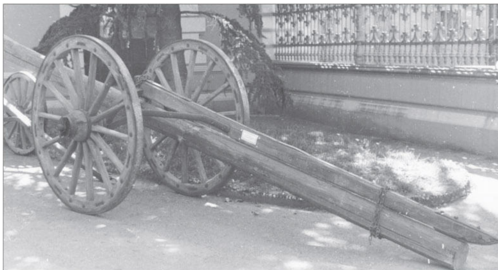
Sostenuto da due ruote poderose, ecco il tróncabäl per il trasporto dei tronchi.
