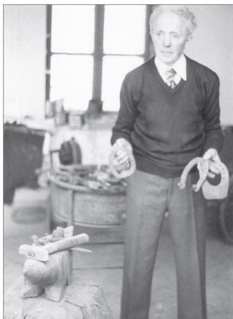
U Nasó mostra alcuni tipi di ferri che variavano a seconda degli animali e delle caratteristiche dei singoli zoccoli. Accanto a lui l'incudine e sullo sfondo la forgia.
