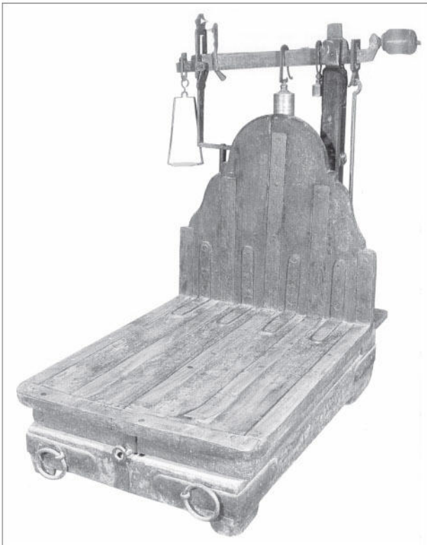
La bascula basacila . Alta e lunga oltre un metro, larga sugli 80 centimetri. Pesa derrate, sementi e altri materiali fino a un quintale. È dotata di un pianale in legno collegato con un'asta graduata sulla quale far scorrere il peso campione fino a raggiungere la posizione di equilibrio. La si ottiene quando combaciano i due beccucci di ottone. Per ottenere pesature superiori o multiple si possono collocare pesi nel piatto. Un piccolo peso misura anche gli ettogrammi.
