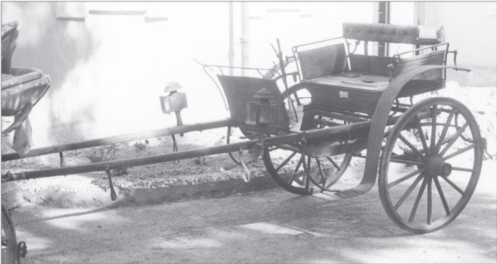
Biròc. Carretto leggero per trasporti veloci di persone e merci leggere. Caratterizzato da paramalta in frassino (legno che si può curvare bene), pédalera , riparo anteriore, cassetina nel sedile e due lampade.
