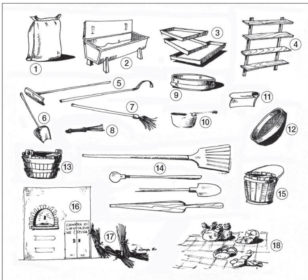
Gli arnesi del fornaio. 1- sac ad farèna, 2- mastra, 3- padèl, 4- as par fa alvà ar pö, 5- tirabràsa, 6- barnàs, 7- scuàs, 8- scuè, 9- şgas, 10- tasa, 11- raspa, 12- cribi, 13- sèbär, 14- pal, 15- sègia, 16- furän, 17- fasiné, 18- mich, biciuló, bufèt, corän.
