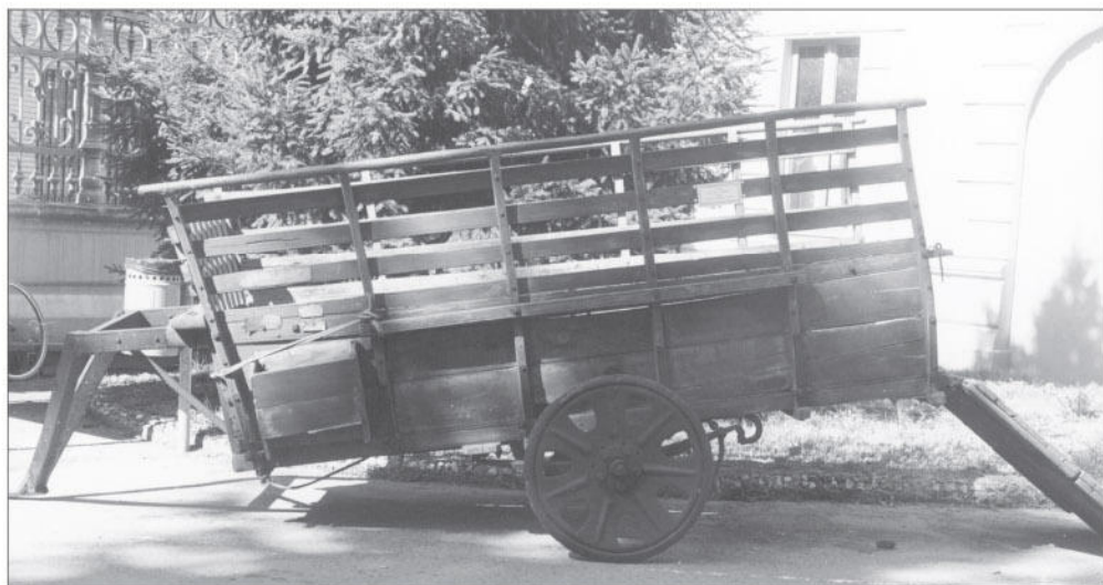
La biga per il trasporto animali. Dotata di un' ántra ribaltabile per il carico e scarico.
