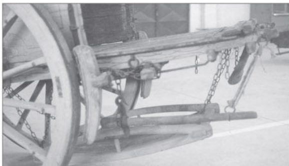
Particolari del carretto. Turnèt per tendere le funi, casèt per gli attrezzi, vapùr.
