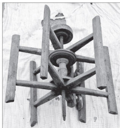
Un'aspa della filanda di Beltramè con ingresso da via De Agostini. Serviva per preparare le matasse.
