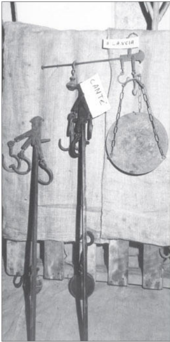
Per pesare: due cantè di diverse dimensioni e una bilancia a piatto.
