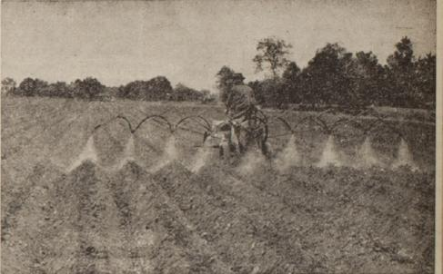
IMPIANTO per DISERBO a PANTOGRAFO variabile (brevetato)
